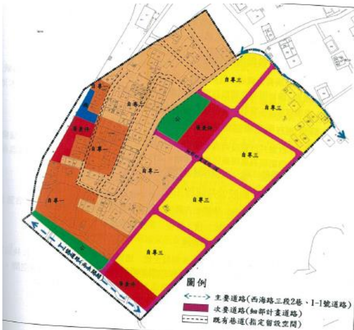
圖 2-3 后豐港自然村道路系統配置示意圖
